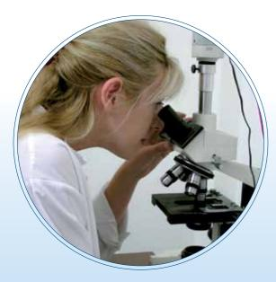
Este modelo resistente y universal es perfecto para la microscopía general en laboratorios, escuelas y universidades. El microscopio MBL2000 puede ampliarse por ejemplo con contraste de fases, un condensador de campo oscuro, el equipamiento de micrómetro, objetivos acromáticos, planos y otros oculares. Un cabezal óptico binocular ofrece visión oblicua y ajuste de la distancia con respecto a los ojos. Una gran gama de accesorios estará disponible para todos los modelos.
